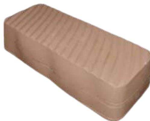
Material adequado para a produção de matrizes de peças, pois permite o reaproveitamento total da massa após a conclusão do molde. No entanto, é importante destacar que esse material não é indicado para pintura e é sensível à temperatura, tornando-se mais rígido em ambientes frios e mais maleável em ambientes quentes.
