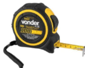
A trena é um instrumento para medição linear e em curvas. É constituída por uma fita de aço flexível, em cuja superfície está gravada a graduação no sistema métrico decimal e em polegadas. Pode ser utilizada em situações envolvendo perímetro e área de grandes superfícies.
